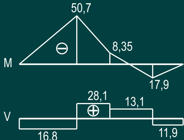
Unter einer Einzellast (Stützkräfte sind auch Einzellasten) hat die  $M$ -Linie einen Knick.
