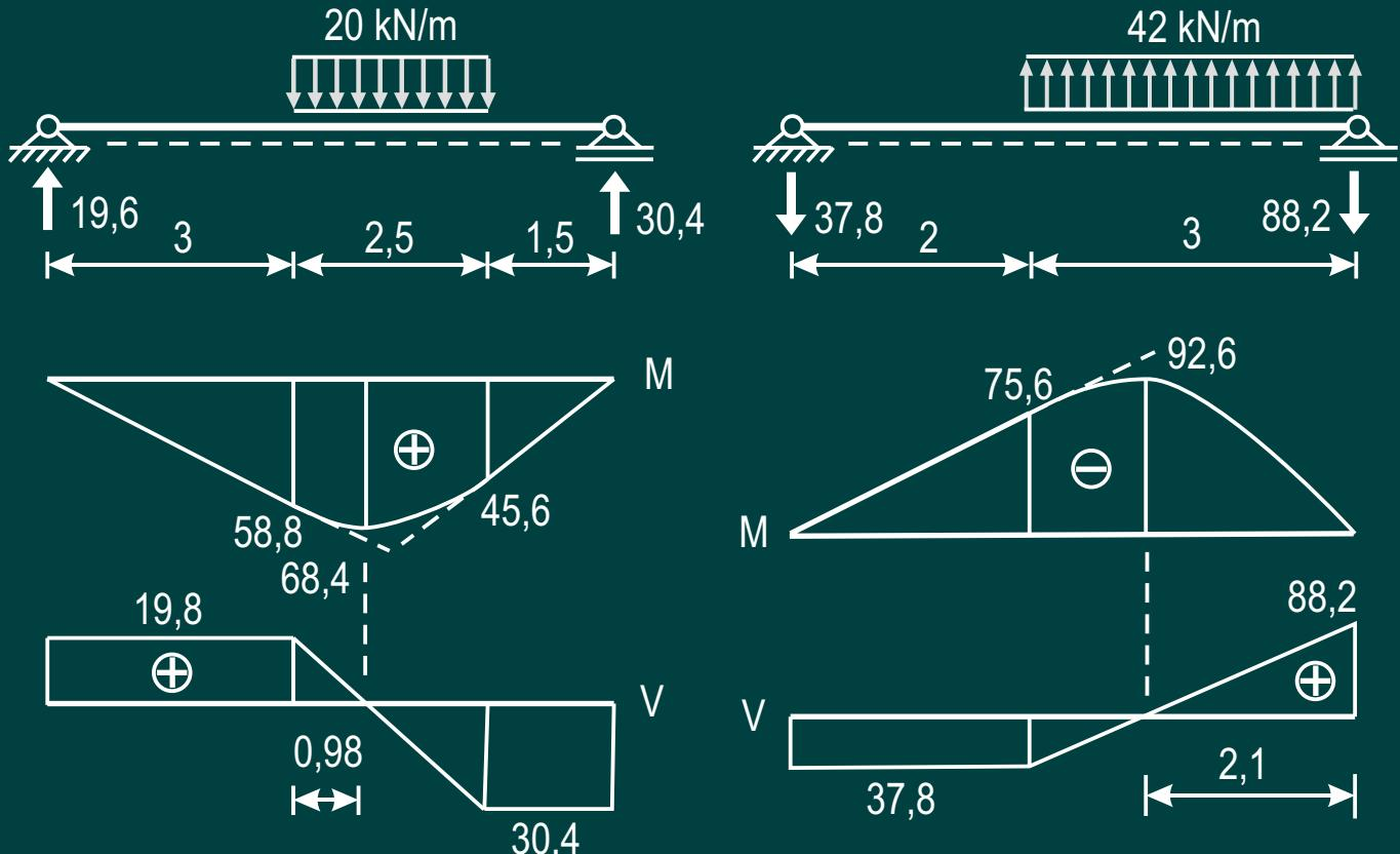
Unter einer konstanten Linienlast ist die M-Linie eine quadratische Parabel. Der Bauch der Parabel zeigt in Lastrichtung. Der Übergang von der Parabel in die Gerade erfolgt tangential.
