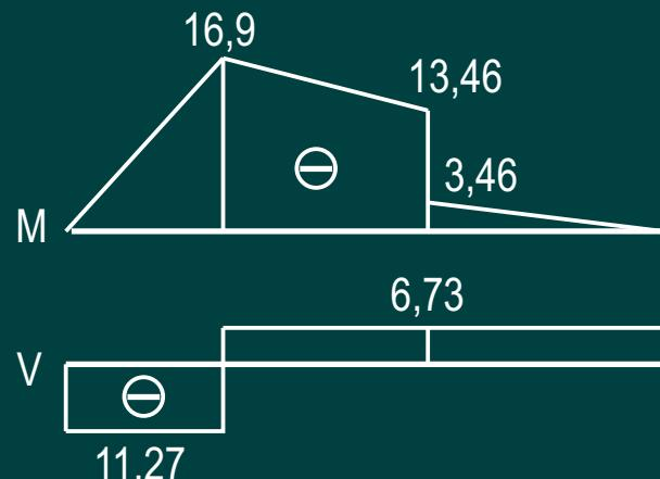
Unter einem Moment hat die M-Linie einen Sprung. Die Sprunghöhe entspricht der Größe des Moments.
