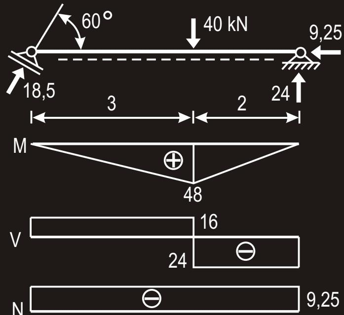
Am schrägen Gleitlager gibt es nur eine Stützkraft. Hat man eine Komponente (die horizontale oder die vertikale), dann hat man über die Winkelbeziehung am Auflager auch die andere.
