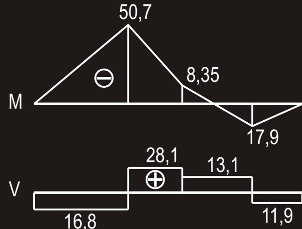
Unter einer Einzellast (Stützkräfte sind auch Einzellasten) hat die M-Linie einen Knick. Der Knick zeigt in Richtung der Pfeilspitze.
