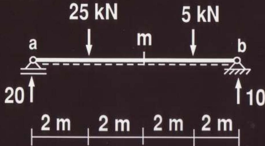
Stützkräfte bereits berechnet.
